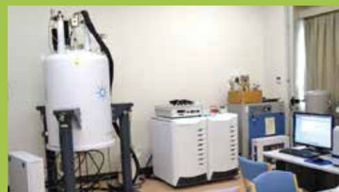
オペラント対応 固体用核磁気共鳴装置 (大学院自然科学研究科に設置)
