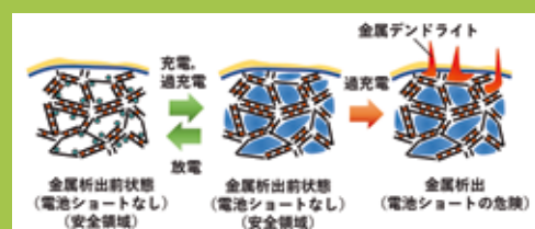
細孔性炭素電極の過充電による金属析出モデル
