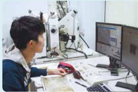
← 電子プローブマイクロアナライザー（EPMA）による岩石の化学組成分析
