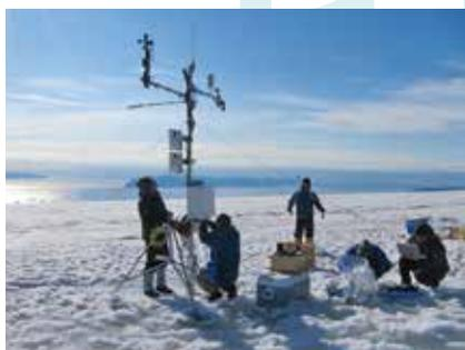
**3** 自動気象観測装置を設置している様子。内陸部3ヶ所に設置し、通年で様々な気象情報を観測しています。
