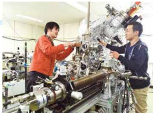
光電子分光装置を使った実験の様子
