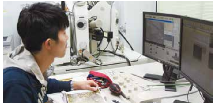
電子プローブマイクロアナライザー（EPMA）による岩石の化学組成分析
