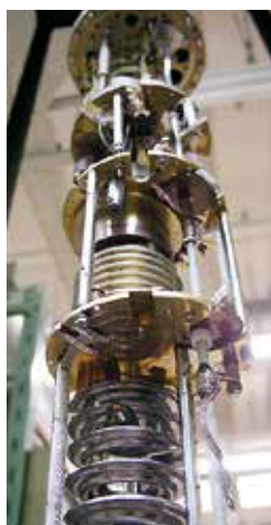
極低温実験に用いる希釈冷凍機
