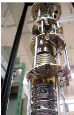
極低温実験に用いる希釈冷凍機
