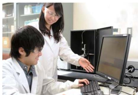
積分半球型蛍光計を用いた発光量子収率の測定
