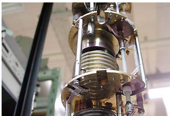
極低温実験に用いる希釈冷凍機
