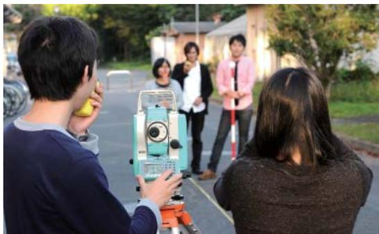
3年次からさらに専門的な講義を履修します。この頃から4年次で取り組む課題研究（卒業研究）を見据え、それに必要な専門科目や関連する分野の講義を選択し、履修します。実験や実習もより高度化し、難しくなりますが、良い結果が得られたときの充実感もひとしおです。自分の進みたい道もこの過程で見つかることでしょう。写真は、「測量・地理情報学実習」での、距離と角度を精密に測定することができる測量機器の取り扱いの練習風景です。
