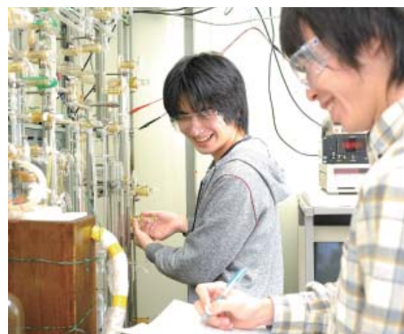
高真空ラインを用いた無機化合物の合成実験
