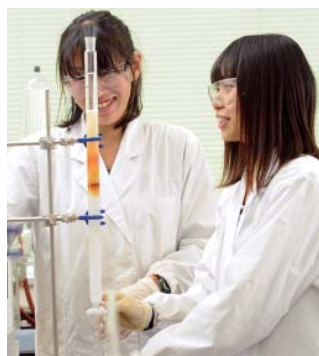
カラムクロマトグラフィーによる有機化合物の分離精製
