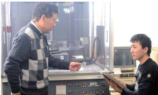
粉末 X 線回折装置で触媒の結晶構造を調べる
