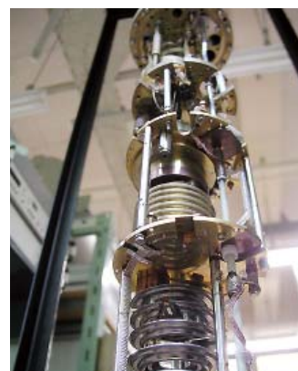
極低温実験に用いる希釈冷凍機
