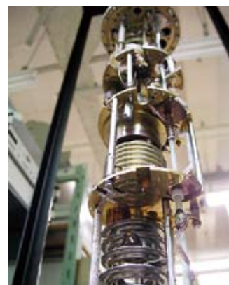
図 1. 極低温実験に用いる希釈冷凍機
