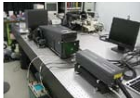
図 3. 岡山大学設置の 波長可変 CW レーザー
