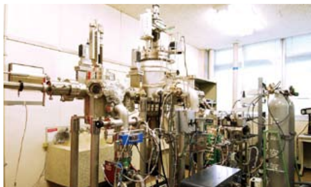
有機エレクトロニクス研究のための分子線エピタキシー装置
