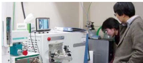
光合成装置を作るタンパク質を高い感度で解析する質量分析装置
